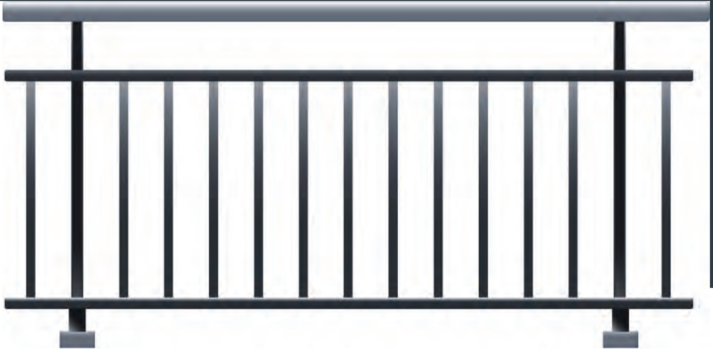
Barreaudage sous la lisse intermédiaire.
